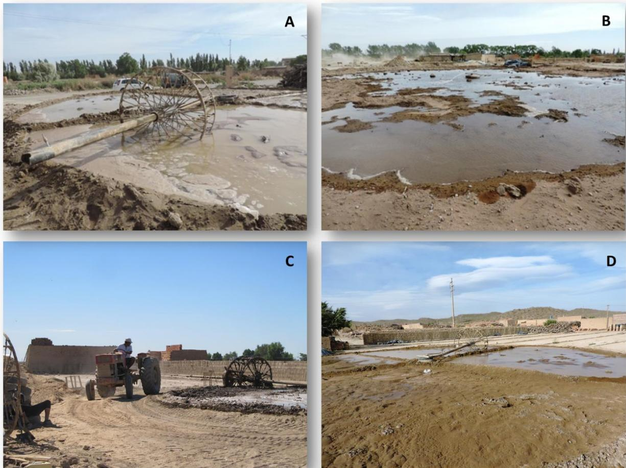
Imagen 5. Pisadero. **A-** se observa la noria con el eje ensamblado listo para mezclar. **B-** en el centro del pisadero se observa el chorro de agua saliendo del caño flexible. **C-** mezclado: tractor moviendo la noria. **D-** vista de otro pisadero con la noria colocada.
