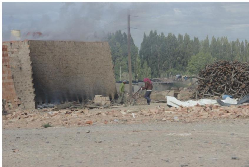
*Imagen 4. Humo de cocción de ladrillos en etapa de horno*
