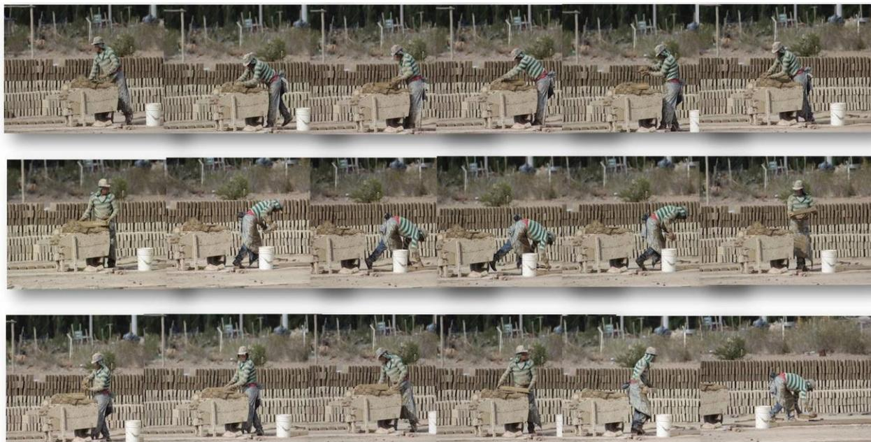
Imagen 8. Secuencia de cortado. Todo el ciclo, desde el rellenado inicial hasta que comienza a rellenar el molde nuevamente, demora menos de un minuto.
