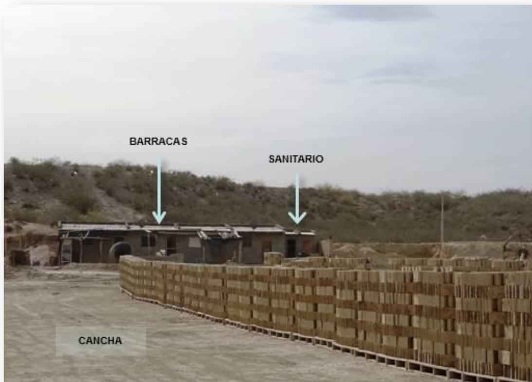
Imagen 2: Zona de Viviendas en Horno. Al frente se observan canchas y adobes apilados en etapa de secado. En el fondo 4 viviendas y un sanitario.
