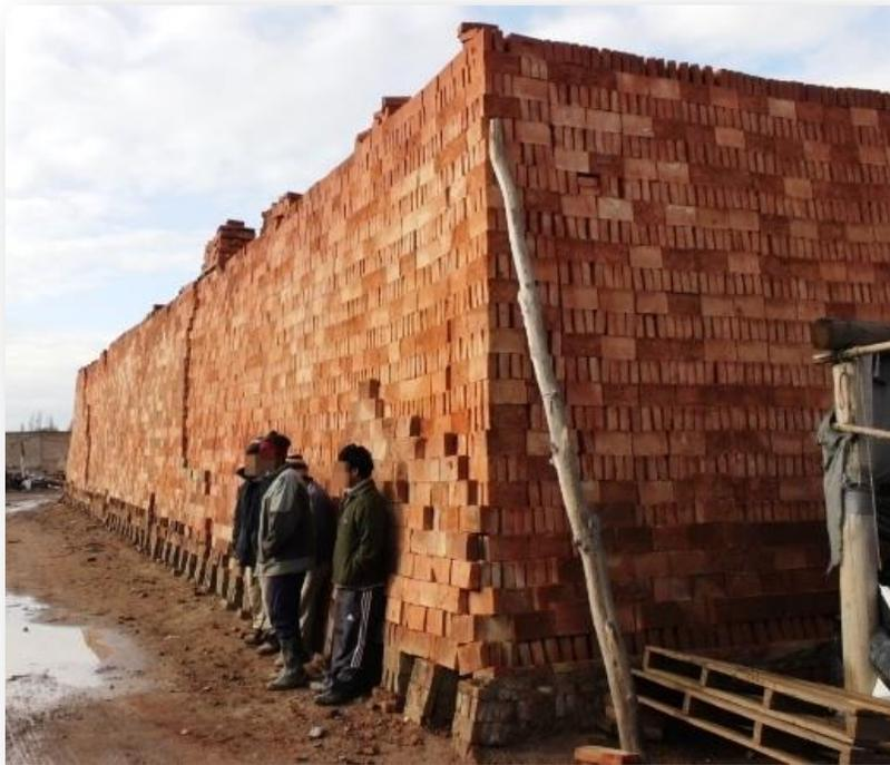
Imagen 14. Hornalla de 160.000 ladrillos, quemada y lista para vender. Tiene más de 30 boquillas. Es la más grande que se relevó durante este proyecto.
