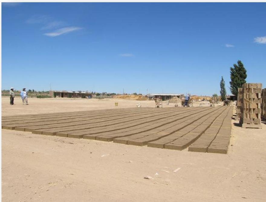
Imagen 9. Barro cortado secando en la cancha. A la derecha se observan las hileras de adobes estibados en pallets para continuar el secado.
