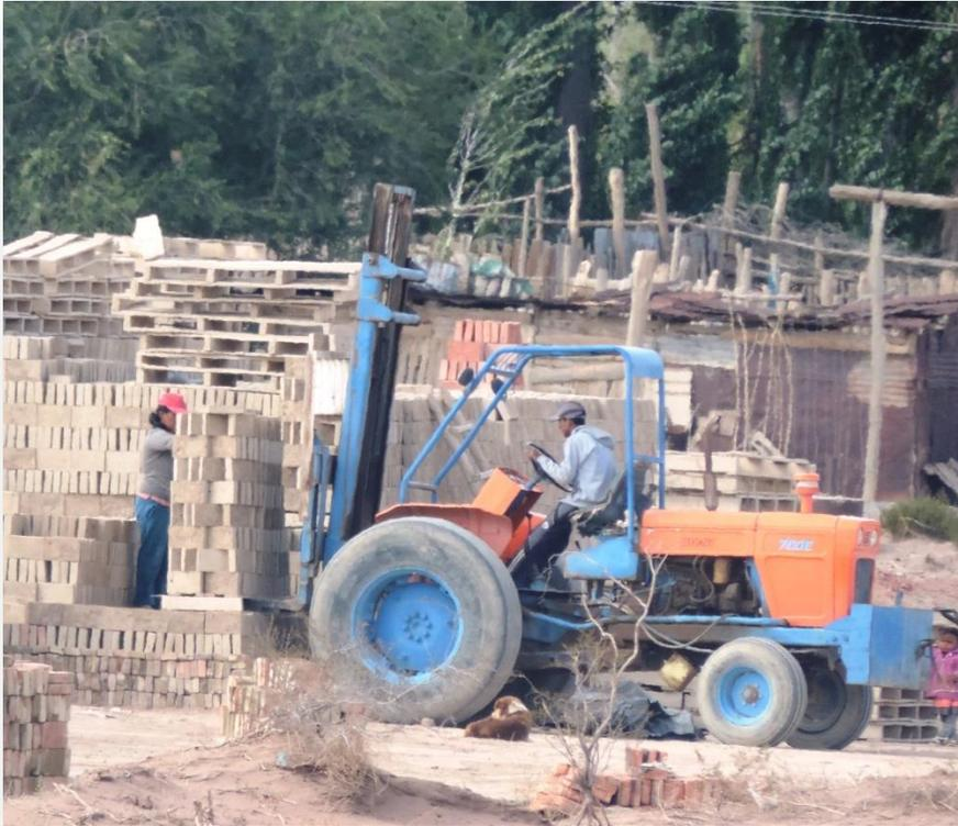
Imagen 11. Trabajador operando montacarga para trasladar un pallet de adobes a la hornalla donde los espera una asentadora para apilarlos.
