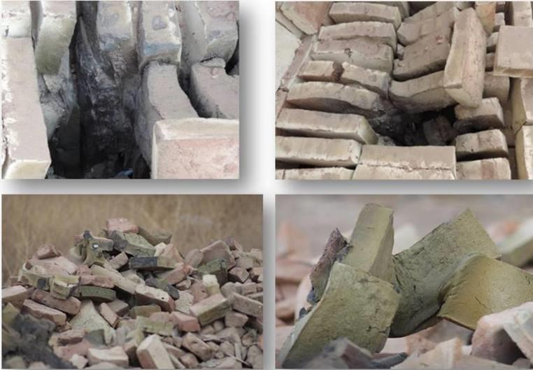
Imagen 19. Ladrillos mal quemados, en este caso, el exceso de temperatura los deforma y les da una consistencia vítrea.
