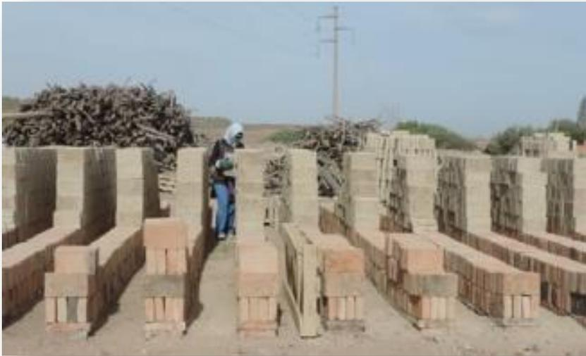
Imagen 15. Primeras etapas del armado de la hornalla. Detrás se observa el acopio de leña.
